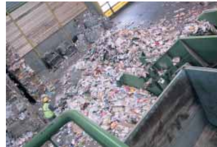
) Les déchets des collectivités sont poussés du box vers le tapis d'alimentation en pente (à droite sur la photo) qui alimente la ligne de tri.
