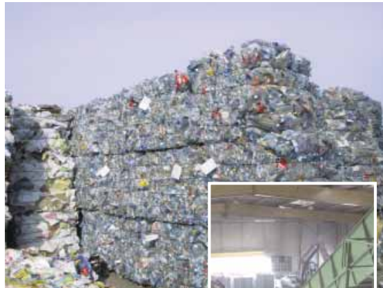
) Triées, pressées et conditionnées en balles de 400 kg, les bouteilles en plastique transparent vont partir pour l'usine de recyclage.
