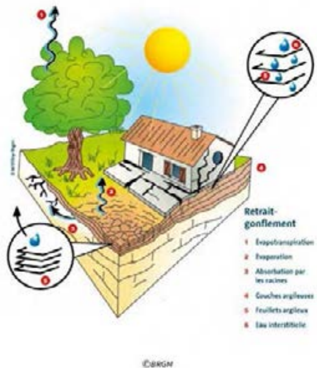
Figure 15. Schéma retrait et gonflement des argiles
