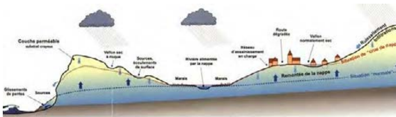
Figure 14. Schéma d'une remontée de nappe - Source : SIGES Seine-Normandie
