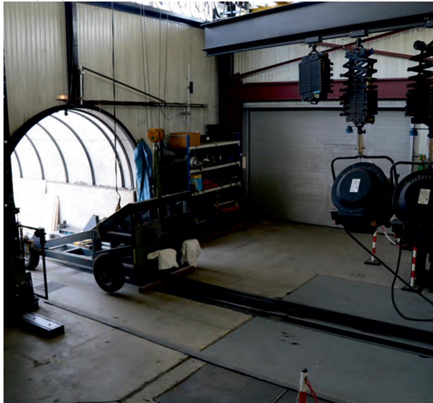
La "catapulte" permettant, entre autres, de réaliser des "crash-tests" de véhicules.
